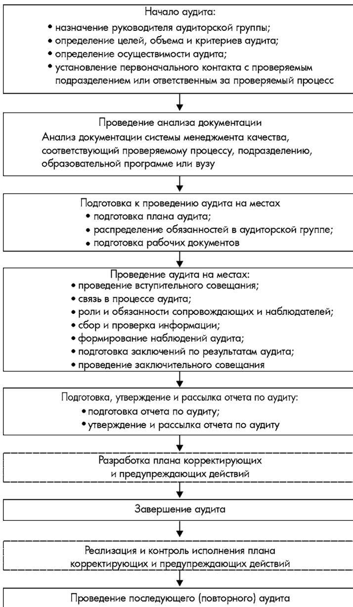
Рис. 8.3. Последовательность действий при планировании и проведении аудита
