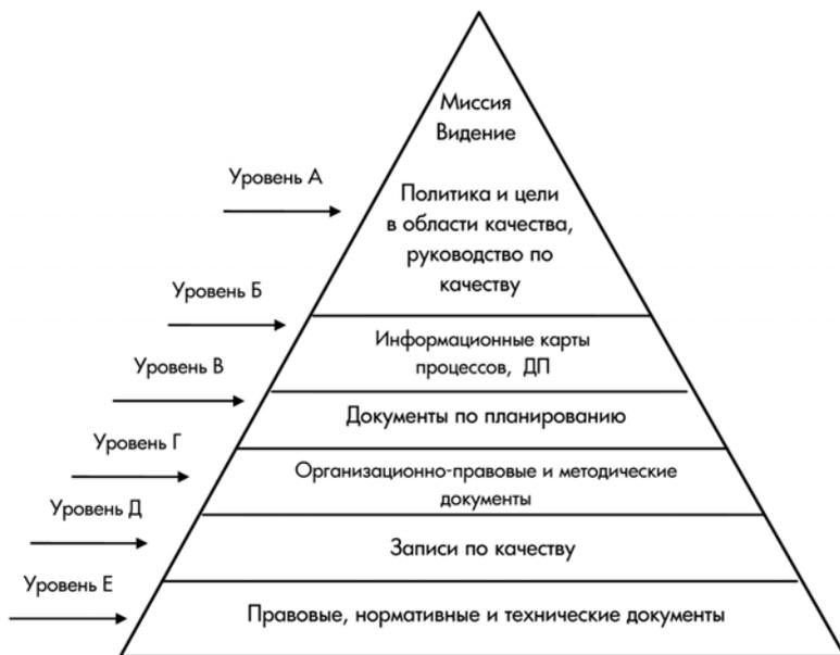
Рис. 4.5. Иерархическая структура документации СК ОУ
